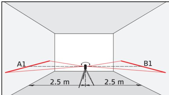
Установите прибор на штативе на равном расстоянии от двух стен (А+В), которые отстоят друг от друга примерно на 5 метров.
