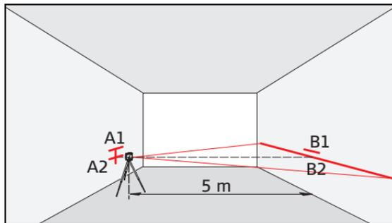
Затем поместите прибор на той же высоте как можно ближе к стене А и снова отметьте горизонтальную линию лазера или лазерную точку на стене А (-> А2). Разверните прибор на 180 градусов снова и сделайте отметку на стене В (-> В2). Измерьте расстояние между отмеченными точками А1-А2 и В1-В2. Подсчитайте разницу между двумя замера. Если разница не более 2 мм, значит точность прибора Leica Lino в пределах допустимого.
