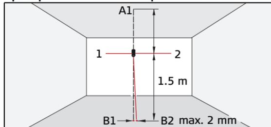
Установите лазер на штатив или на кронштейн для настенного монтажа рядом с точкой A1 на минимальном расстоянии 1.5 м от точки B1. Горизонтальная линия лазера выровнена в направлении 1. Отметьте лазерные точки A1 и B1 маркером.
