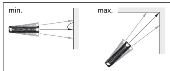
Чаще всего эта функция используется для измерения диагоналей (максимальные значения) или горизонтальных расстояний до вертикальной поверхности (минимальное значение).
